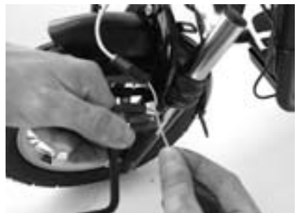
6. Sie können jetzt die Imbusschraube am linken Bremsarm lösen, den Bowdenzug ein wenig weiter spannen und danach die Schraube festziehen. Spannen Sie den Bowdenzug in kleinen Schritten (1 cm ist schon viel!!).
